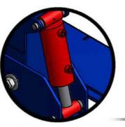
THE TILT OPTION IS PARTICULARLY USEFUL IN SIDE HILL OPERATIONS OR FOR PRE PRUNING, IT ALLOWS THE OPERATOR TO PUSH THE IMPLEMENT 16 DEGREES IN EITHER DIRECTION FROM THE TRACTOR SEAT.
